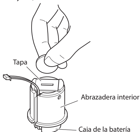
Imagen 23 Retirada de la tapa de la batería
